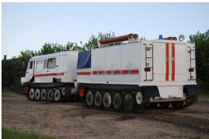
*Рисунок 6 – Аварийно-спасательная машина на базе двухзвенного гусеничного снегоболотохода (АСМ-ГД)*
