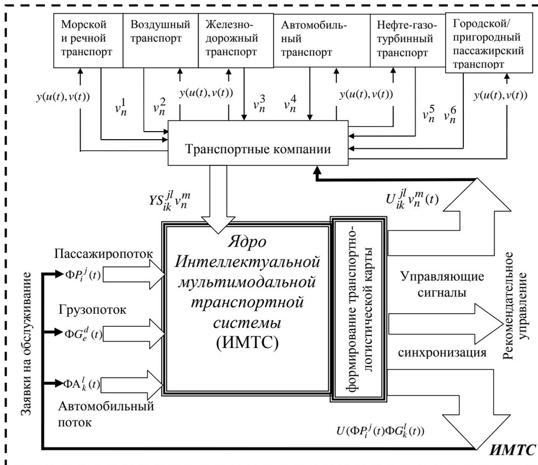
Рисунок 1 – Интеллектуальная мультимодальная транспортная система как система обслуживания запросов и выработки управляющих воздействий
