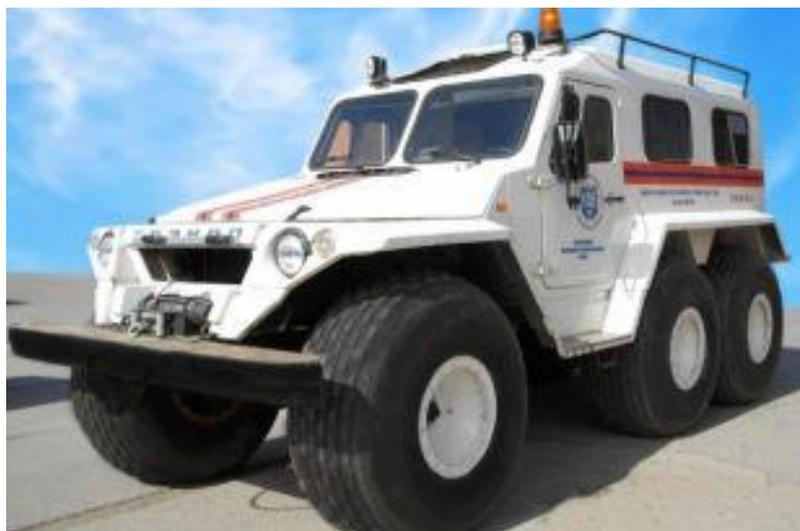
*Рисунок 9 – Вездеход на шинах низкого давления типа «Трэкол»*
