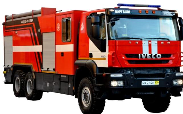
*Рисунок 5 – Пожарная автоцистерна АЦ-С 8,0-70 на шасси IVECO АМТ 6339*
