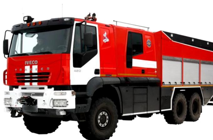
*Рисунок 4 – Пожарно-спасательный автомобиль ПСА-С 6,0-40 (6339) в климатическом исполнении ХЛ*
