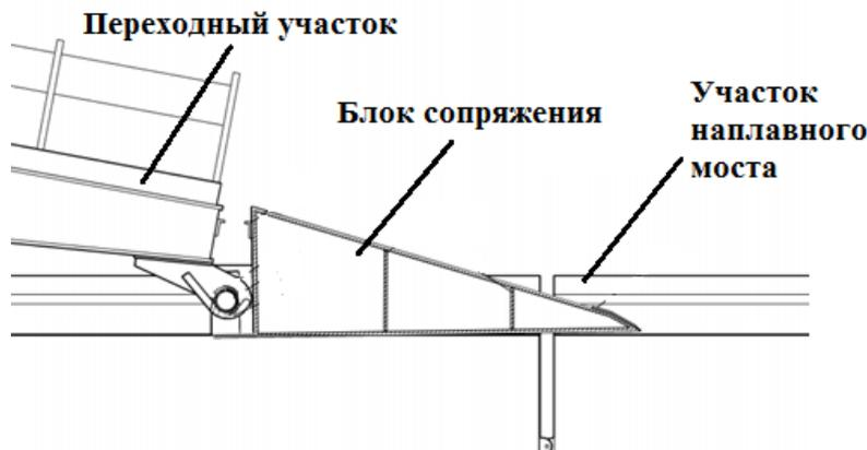
Рисунок 4 – Блок сопряжения в рабочем положении
